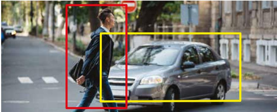
Regolabile se devono essere rilevate persone, veicoli motorizzati o non o solo movimenti. È inoltre possibile regolare l'area di rilevamento e la sensibilità.
