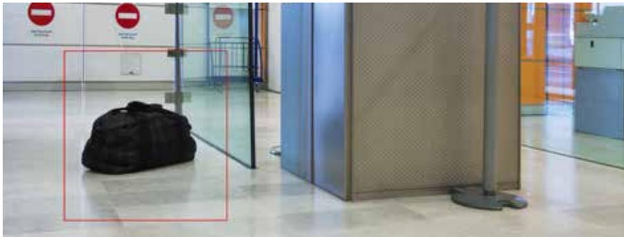
La funzione di rilevamento “oggetti abbandonati/rimossi” offre due opzioni di utilizzo: è possibile identificare rapidamente gli oggetti che si trovano in un’area predefinita oppure la funzione può essere utilizzata anche per rilevare la rimozione di oggetti in quest’area.
