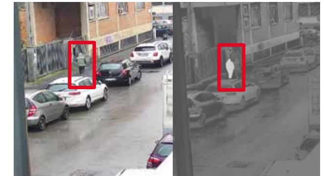
Rilevamento con termica biottica
